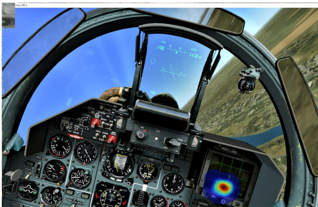
Фиг. 4. „Heat Map“, получена с окулограф Gaze Point GP3 HD на симулатор Lock On Flaming Cliffs 2
